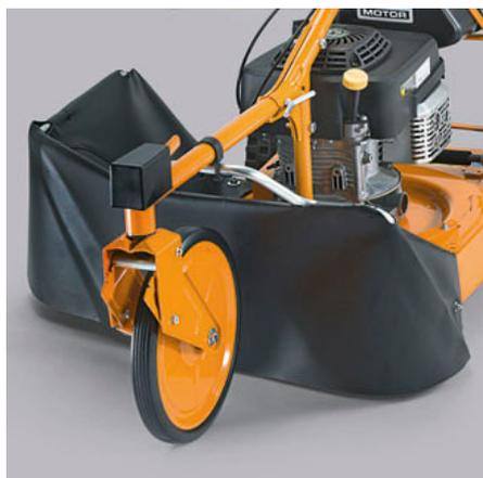
**Steinschlagschutz**tuch für erhöhte Sicherheit.
